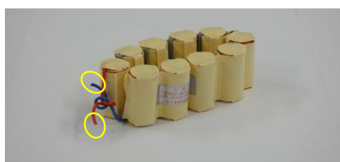
(固定されていない電池パック)
