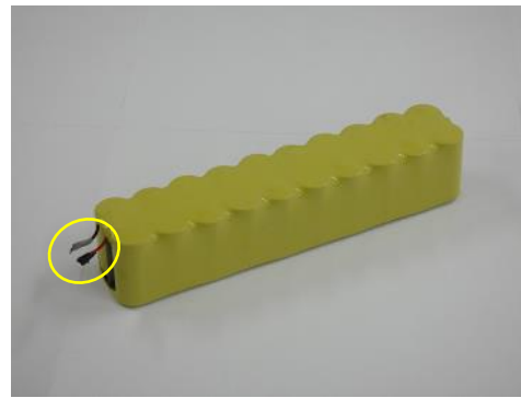
(リード線切断部を1本ずつ被覆)
